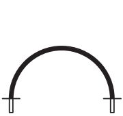
Halbrundbogen Arc semi-circulaire Semi-circular arch
