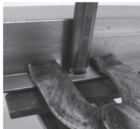
Reibwerkzeug 499.325 im Einsatz Comment utiliser l'outil d'alésage 499.325
