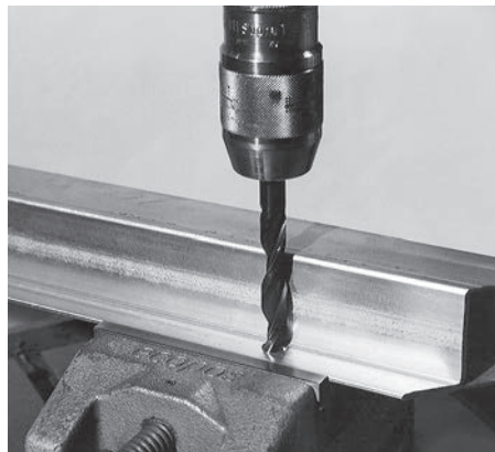
Bohren auf Ständer-Bohrmaschine Perçage sur machine à percer verticale Drilling using upright drilling machine
