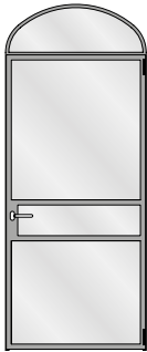
Einflügelige Türe mit Korbbogen-Oberlicht Porte à un vantail avec imposte anse de panier Single leaf door with oval arch top light
