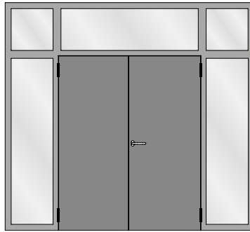
Verblechte zweiflügelige Türe mit zwei festen Seitenteilen und festen Oberlichtern Porte tôlée à deux vantaux avec deux parties latérales fixes et impostes fixes Sheet metal double leaf door with two fixed side lights and fixed top lights
