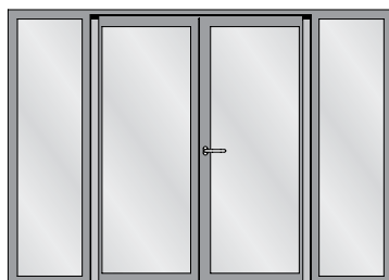
Zweiflügelige Türe mit zwei Seitenteilen Porte à deux vantaux avec deux parties latérales Double leaf door with two side lights
