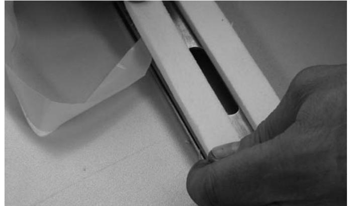
Abb. 13 Positionnement de la bande de fibre de céramique au dos du profilé de fixation
