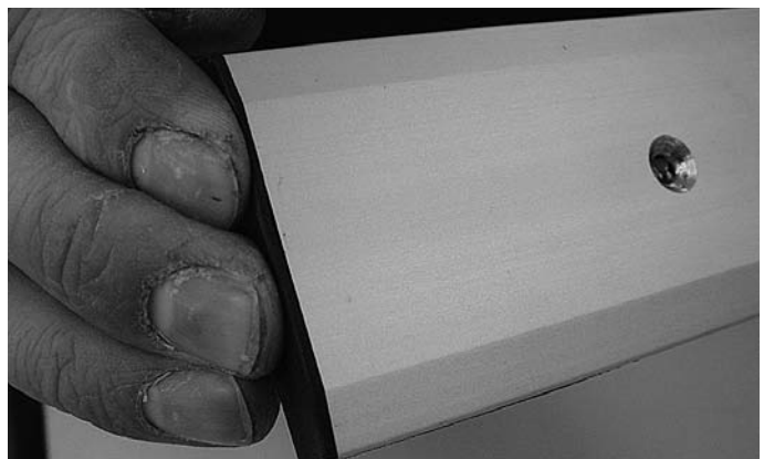
Abb. 79 Dichtungs-Formstück an Anschraubprofil andrücken Fig. 79 Presser le joint de bout sur le profilé à visser
