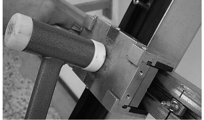
Abb. 35 Kräftiger Hammerschlag auf die Ausklinklehre Fig. 35 Coup de marteau puissant sur gabarit d'entaille
