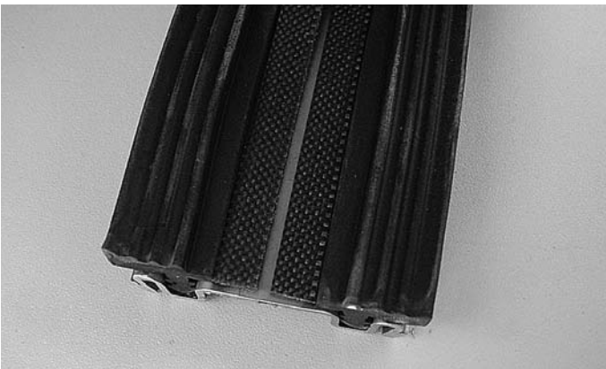
Abb. 76 Abschliessend Schutzfolie weiter abziehen und Brandschutzlaminat-Streifen fortlaufend andrücken. Fig. 76 Enfin, retirer encore le film protecteur et presser en continu sur la bande de protection-incendie.
