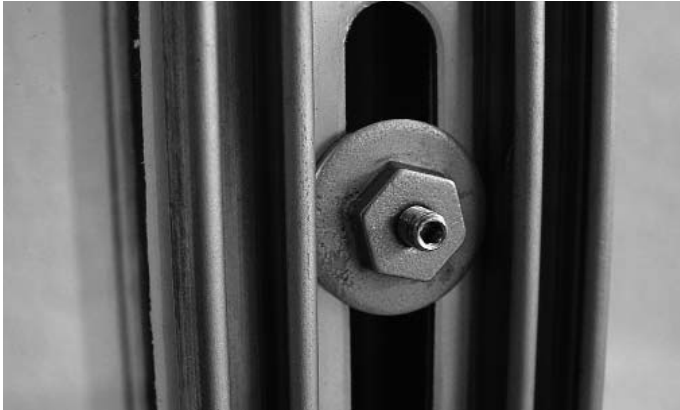
Abb. 19 M4-Spezial-Zentriermutter für die Montage der Anpressprofile. Überstand Gewindestift min. 2 mm. Fig. 19 Ecrou de centrage spécial M4 pour le montage des profilés de fixation. Dépassement de la vis sans tête min. 2 mm.
