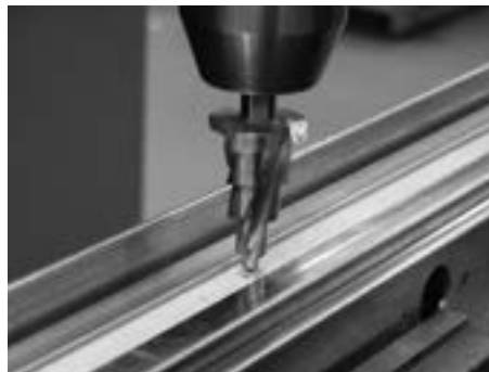
Schlitzmarkierung mit Universalbohrer 499.340 aufbohren Perçage du marquage de la fente avec foret à étages 499.340 Drill out the slot marking using multipurpose step drill 499.340
