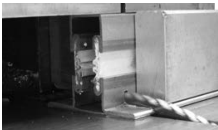
Riegel-Enden im Lappenbereich ansägen Entailler les extrémités de la traverse dans la zone de la lèvre Give the transom ends a cut with the saw in the overlapping area
