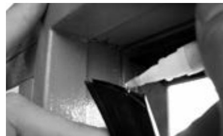
Gehrungsecken verkleben Coller les angles d'onglet Gluing the mitre corners
