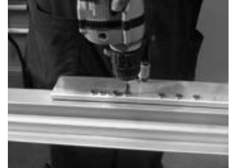
Markierungsbohrungen für Drücker und Zylinder Perçages de marquage pour poignée et cylindre Marking holes for the handle and cylinder
