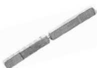
555.593 Geteilter Drückerstift Vierkant 9 mm, Stahl gehärtet, verzinkt, Länge 50 + 50 mm, für Türstärken bis 50 mm
