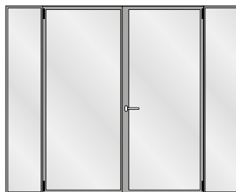
Zweiflügelige Türe mit zwei festen Seitenteilen Porte à deux vantaux avec deux parties latérales fixes Double leaf door with two fixed side lights
