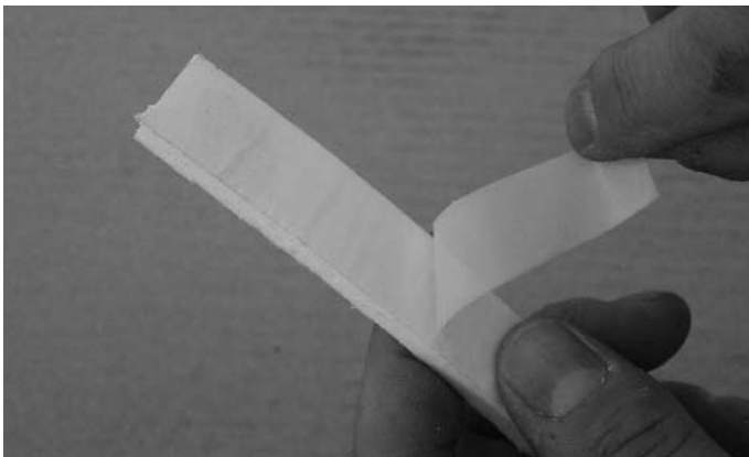
Abb. 1 Klebefolie beim Keramikfaserband abziehen Fig. 1 Retirer le film adhésif de la bande de fibre de céramique
