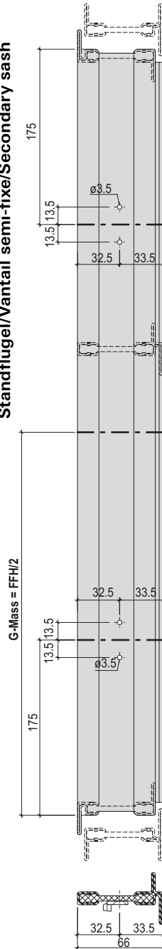
Découpe prolongement de la crémonne Schéma de perçage prolongement de la crémonne et gâches FFH 670-1269
