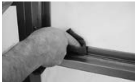
Reinigung Profilanschlag Nettoyage aile fixe du profilé Cleaning section stop
