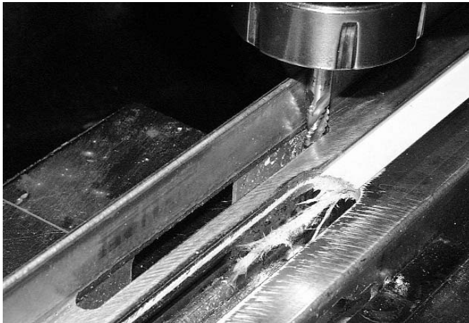
Abb. 7 Schlitz für Bohrschutzplatte Fig. 7 Rainure pour la plaque de protection anti-perçage
