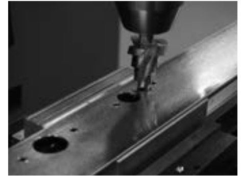
Zylinderschlitz ausfräsen Fraisage de la fente destinée au cylindre Machine out the cylinder slot
