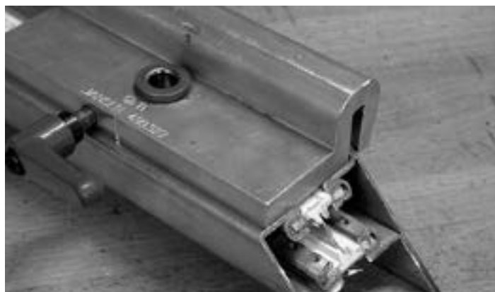
Lehre positionieren und anklemmen Positionner le gabarit et le serrer Locating and fixing the jig
