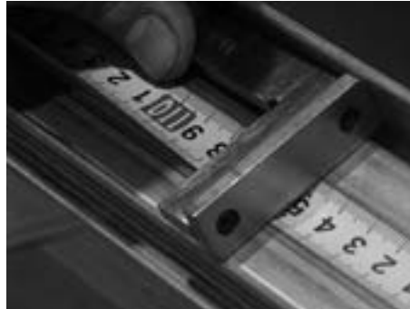
G-Mass anzeichnen Repérage de la cote G Mark the G measurement
